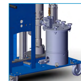
Alimentación mediante depósito a presión
