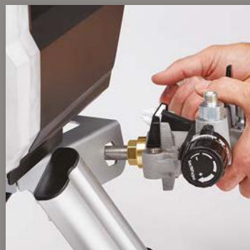
3. UTILICE EL BASTIDOR PARA EXTRAER EL CARTUCHO
