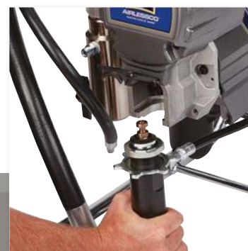
2. LEVANTE LA TAPA Y DESMONTE LA BOMBA
