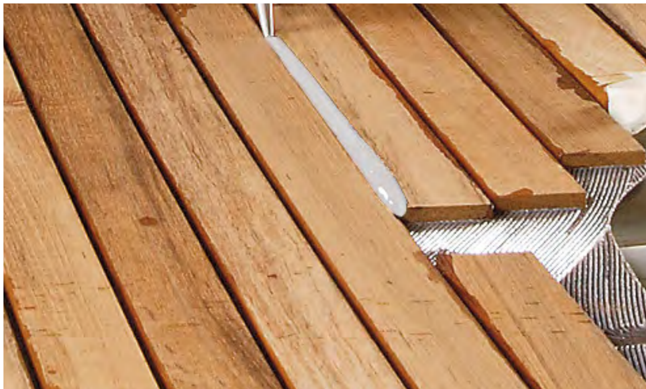
Con adhesivos de dispersión, por ejemplo, se pegan cubiertas de barcos de madera. En este caso, se requiere la resistencia al agua del adhesivo.
