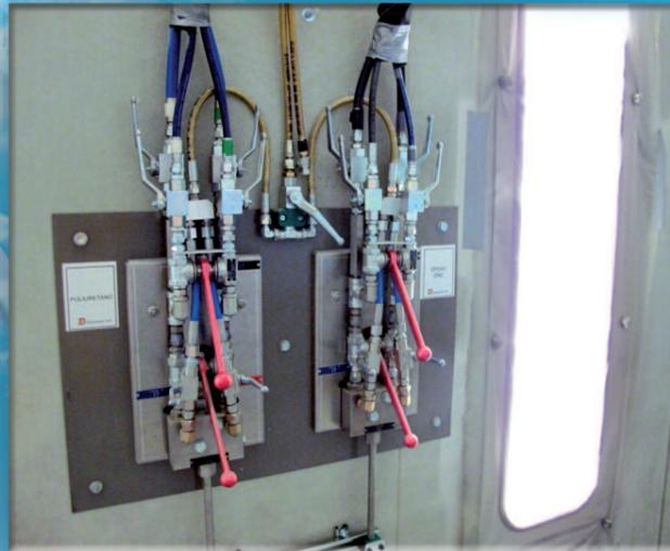
La instalación se compone de 4 cabinas con 12 unidades de cajas de mezcla de presión con recirculación (foto superior), cada una de las cajas destinada a la mezcla de los 6 componentes correspondientes a los tres productos finales distintos (epoxy zinc, epoxy cerámico y poliuretano), además de dos tipos de disolventes.
