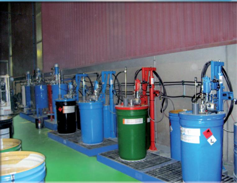
Los bidones de 200 lts del fabricante listos para agitar y trasvasar el material al siguiente sistema de alimentación.
