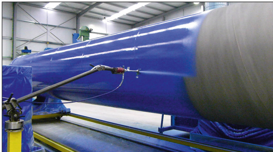
En las fotos inferiores de la página de la izquierda: Ángel Contreras en uno de los montajes (izquierda) y Miguel Ángel Martín programando un sistema automático para el pintado de tubos que en la imagen superior, se encuentra en pleno funcionamiento.
