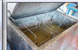
Depósito para baño de decapado y cabina de mangas para lavado a presión.
