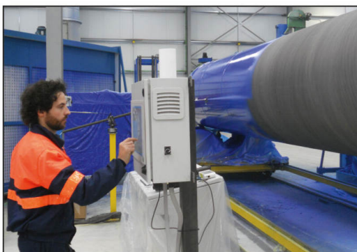
Sala de mezclas para productos de alta viscosidad (izquierda), para alimentación de producto en sistema automático de pintado de tubos y aplicación (derecha) con la puesta ya en marcha del sistema.
