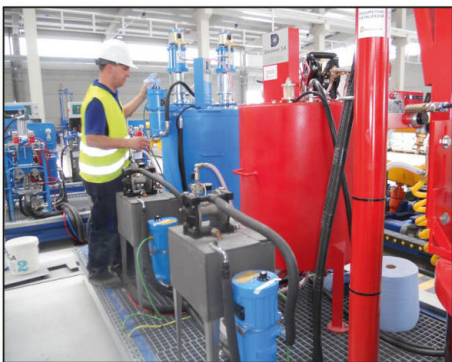
Sala de mezclas para productos de alta viscosidad (izquierda), para alimentación de producto en sistema automático de pintado de tubos y aplicación (derecha) con la puesta ya en marcha del sistema.
