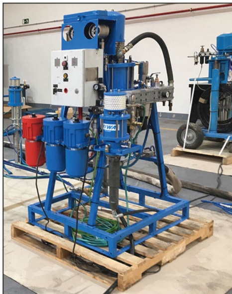
Equipo airless de dos componentes. Epoxy y/o poliuretanos.
