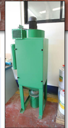
Cabina de mangas cerrada, para limpieza de lijadoras y aspiradores, y depósito aspirador para extracción de polvo.
