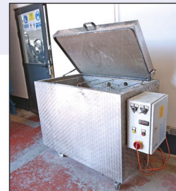
Depósito para baño de decapado y cabina de mangas para lavado a presión.
