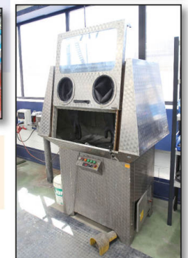
Depósito para baño de decapado y cabina de mangas para lavado a presión.
