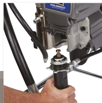
2. LEVANTE LA TAPA Y DESMONTE LA BOMBA
