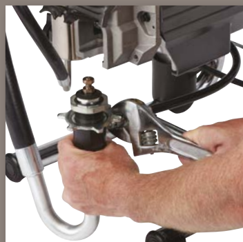
3. DESCONECTE LAS MANGUERAS
