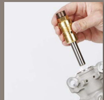
4. INSTALE EL NUEVO CARTUCHO Y SUSTITUYA LA BOMBA
