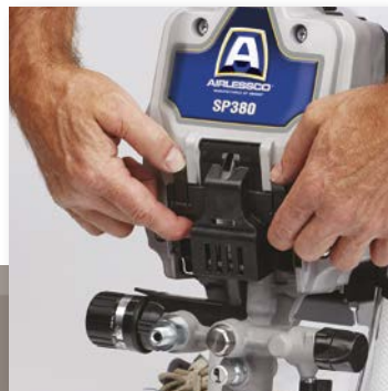
1. DESLICE Y ABRA LA TAPA DE ACCESO
